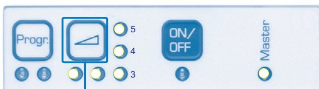
Rollierendes Pausieren beim Betrieb mit ungeraden Stationen ist im Auslieferungszustand eingeschaltet. Durch Drücken der Speed-Taste für ca. 1 sek, wird dieser Modus deaktiviert. Als Bestätigung dazu leuchten alle 5 Speed LEDs.
